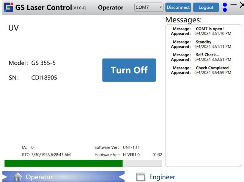
5. 如果激光器为自动开机模式，则自动加载电流；如果为手动开机模式，则需要手动加载电流，加载电流完成后进入工作模式，如下图所示。
