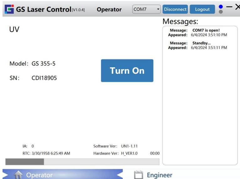
3. 点击“Turn on”按钮,变为“Turn off”后,Messages 栏将显示“Self-Check...”,此时激光器进入预热过程。
