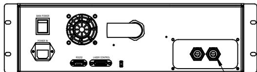
接外径10mm内径6.5mm水管
